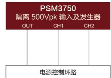
上图表明，PSM3750 剔除了必用的隔离变压器和差分探头，另外在传统的 FRA 执行分析时，需要几个隔离变压器作用在不同频率范围，PSM3750 也解决了这个麻烦，其输出信号产生频率涵盖整个频率范围。
