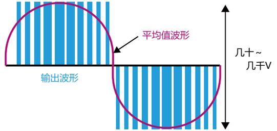
当在测试变频器上臂的Vce或Vge时,以输出波形为基准测试Gate电压, Collector电压, 像一般附带示波器的单端探头不能在此类应用上。
