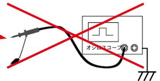
以前此类测试使用差分探头, 但有时会出现波形歪曲, 由于共模噪声抑制比或耐共模电压的限制, 有时确保充足的测试带宽会出现困难。若使用光缆, 隔离测试系统可以精确地观测信号, 而不受这些限制地影响。
