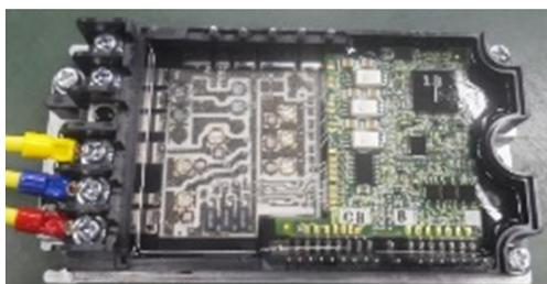
【図2：インバータモジュール内部】
