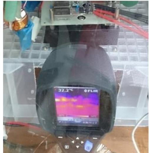
【図 58. インバータの電力測定時の温度計測】
